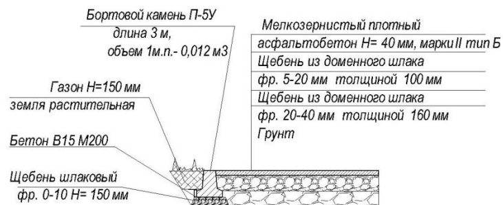
Схема 3 Конструкция покрытия тротуара Примыкание к газону
